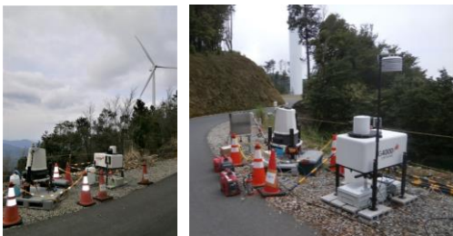
図 6. 山岳地形の発電所に設置された Galion Lidar
