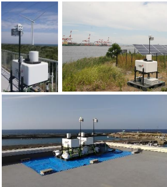
図 7. Galion Lidar 洋上風況調査 (上段左：神栖市, 大阪市, 下段：洲本市)
