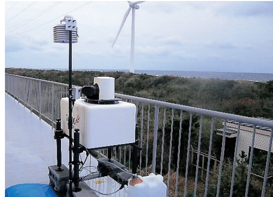
洋上風況調査を実施中のドップラー・ライダー
