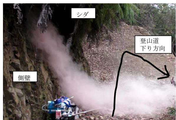
図 2 淡路ヶ峠東斜面中腹における側壁に沿った下降流の煙による可視化
