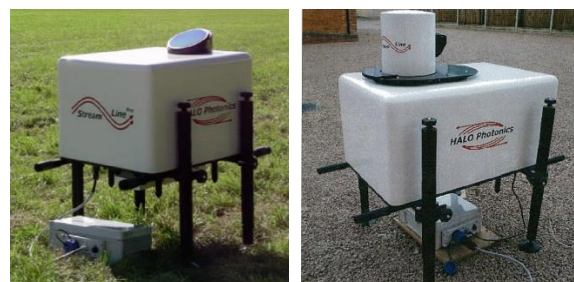
図 3. 鉛直型 StreamLinePro(左)とスキャニング型 StreamLineXR(右)
