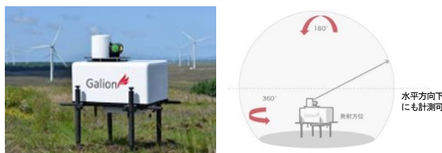
図 2. Galion Lidar(左)と測定範囲の説明(右)
