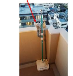
比較対象として近郊の城東区関目マンションに設置した温度計（強制通風式）北側階段のため日陰となる
