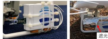
搭載センサー：気温（NTCサーミスタ）、湿度（静電容量センサ）、気圧（圧電式センサ）
