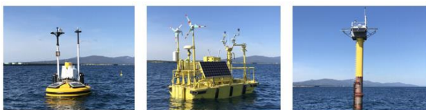
図 3.9 使用したフローティングライダー 42) SEAWATCH (左), WindSentinel (中), MIA (右)
