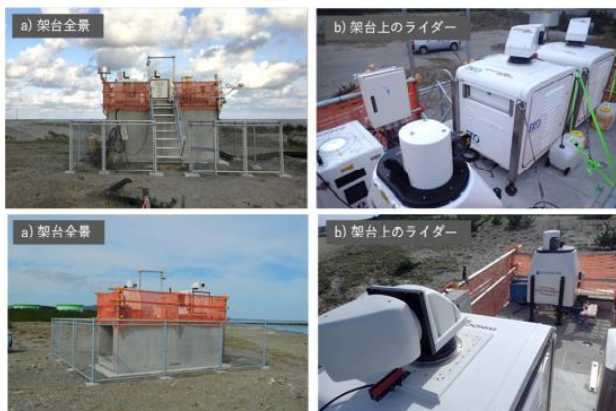
図 3.8 陸上サイトライダー設置状況 42)
